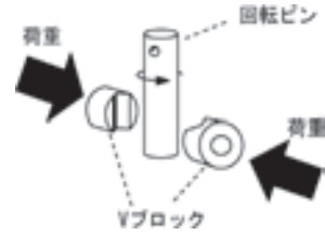
図1 FALEX 摩擦試験
